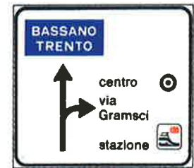
N. FIGURA 233 PREAVVISO DI INTERSEZIONE URBANA
