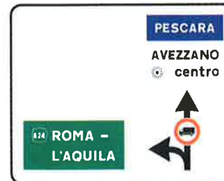
N. FIGURA 239 PREAVVISO DI INTERSEZIONE URBANA
