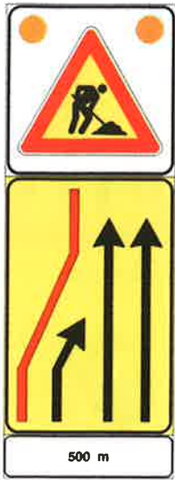
N. FIGURA 399 PRESEGNALE DI CANTIERE MOBILE
