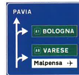
N. FIGURA 235 PREAVVISO DI USCITA AUTOSTRADA
